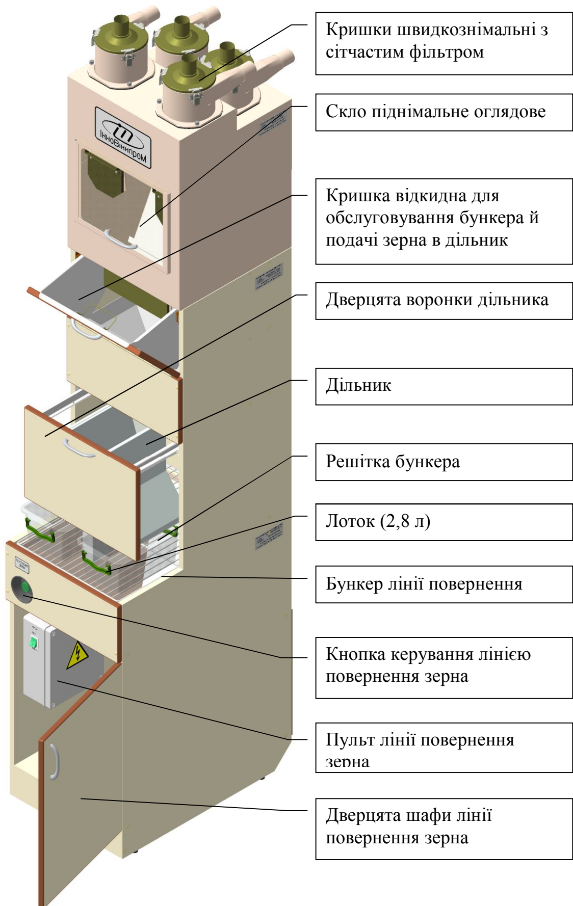
Мал. 2. Складові частини шафи лабораторної ШЛ-2.4
