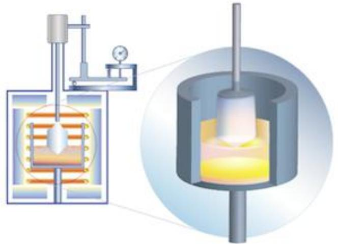
Кристаллизация происходит в расплаве, но монокристалл медленно вытягивается из расплава по мере уменьшения объёма расплава. Существенной проблемой является непостоянство скорости выращивания, поскольку теплообмен по мере увеличения массы монокристалла претерпевает изменения, учесть которые технически сложно. Поэтому скорость роста задаётся заведомо низкой (порядка 2 мм / ч), чтобы избежать возможного образования в монокристаллах различного рода включений, блоков и малоугловых границ.
