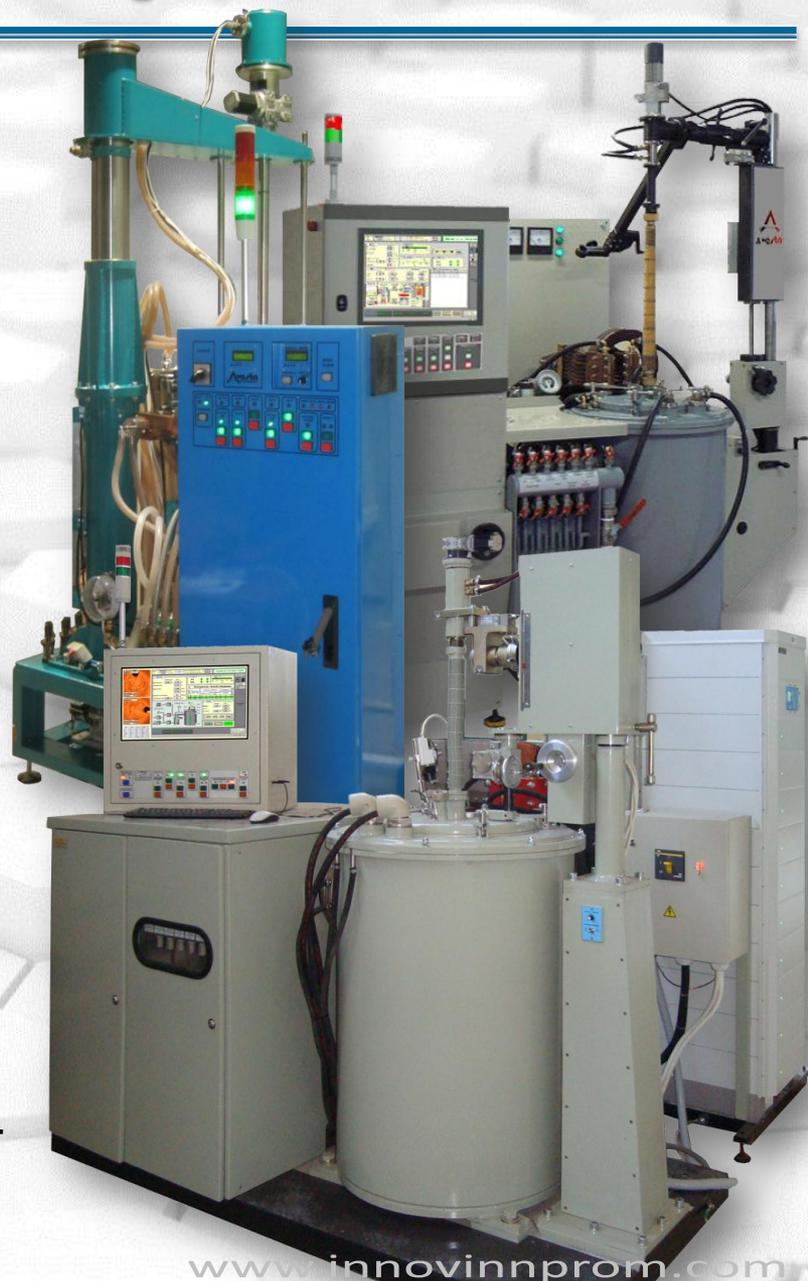
С целью недопущения срыва технологического процесса выращивания кристалла и разрушения теплового узла реализована многоуровневая отказоустойчивая архитектура АСУ ростовых установок
