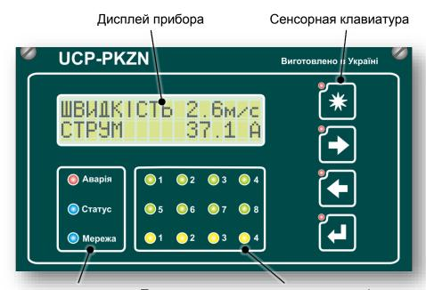
Панель индикации режимов Панель индикации состояния входов/выходов
